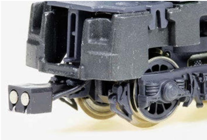
Das Lokgehäuse ist abgenommen, der PEHO Kupplungskopf ist in den ...
