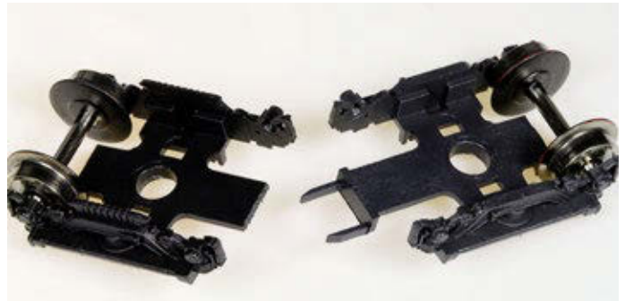
Die «Gabeln» an den Drehgestellen braucht es nicht mehr, also weg damit!
