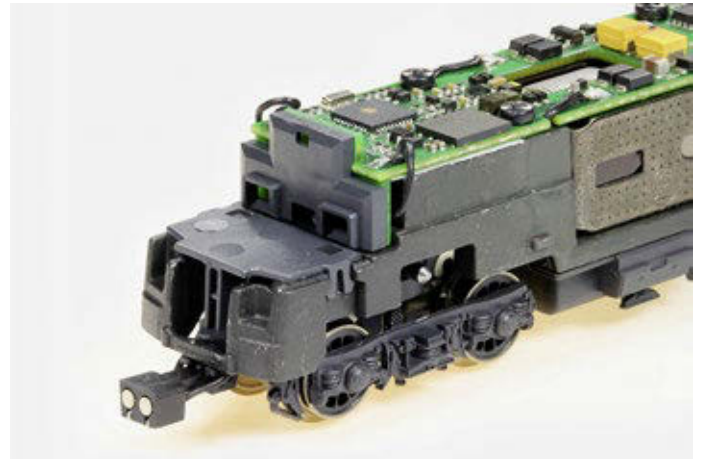
... N-Normaufnahmeschacht eingesteckt und die beiden Kabel sicher verlegt.
