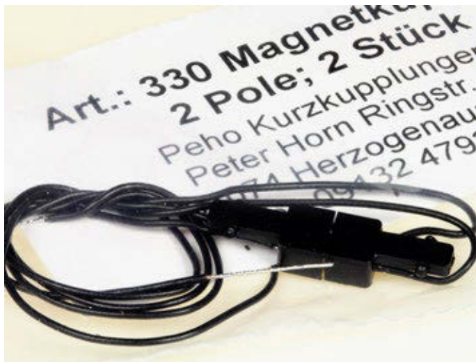
Die magnetischen, elektrisch leitenden PEHO-Kupplungsköpfe werden ...
