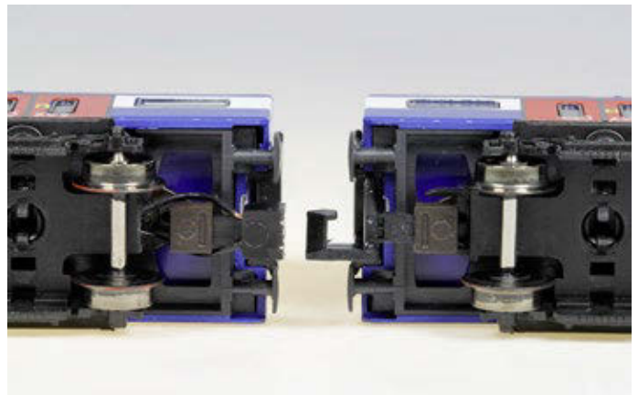
... N-Normkupplung (rechts) mit den kleinen Änderungen am Drehgestell.
