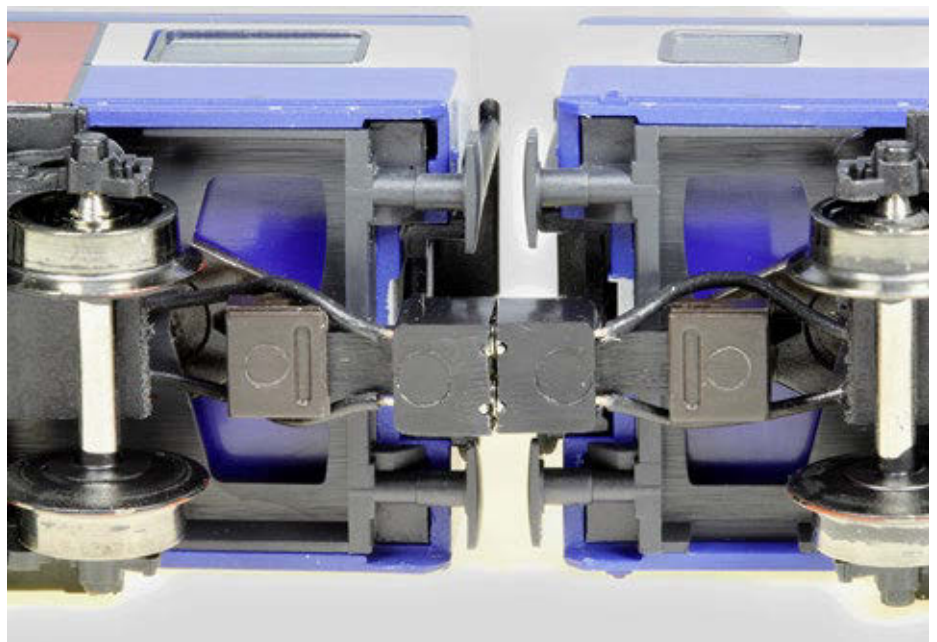
Die Situation nach dem Umbau von unten betrachtet zeigt den freien Schwenkbereich der Litzen.
